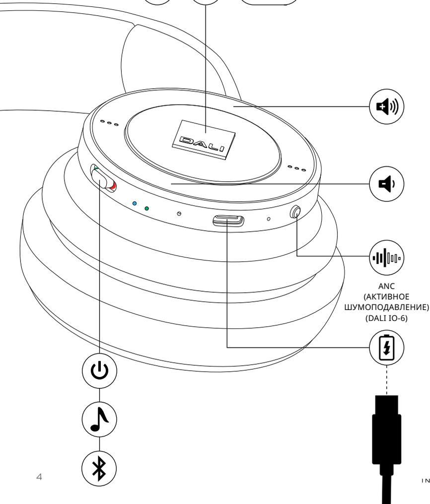
DALI IO-4 и IO-6 — это беспроводные наушники Bluetooth на аккумуляторах, которые также можно подключать как через USB, так и с помощью обычного проводного соединения. Модель IO-6 дополнительно имеет функцию активного шумоподавления (ANC).
