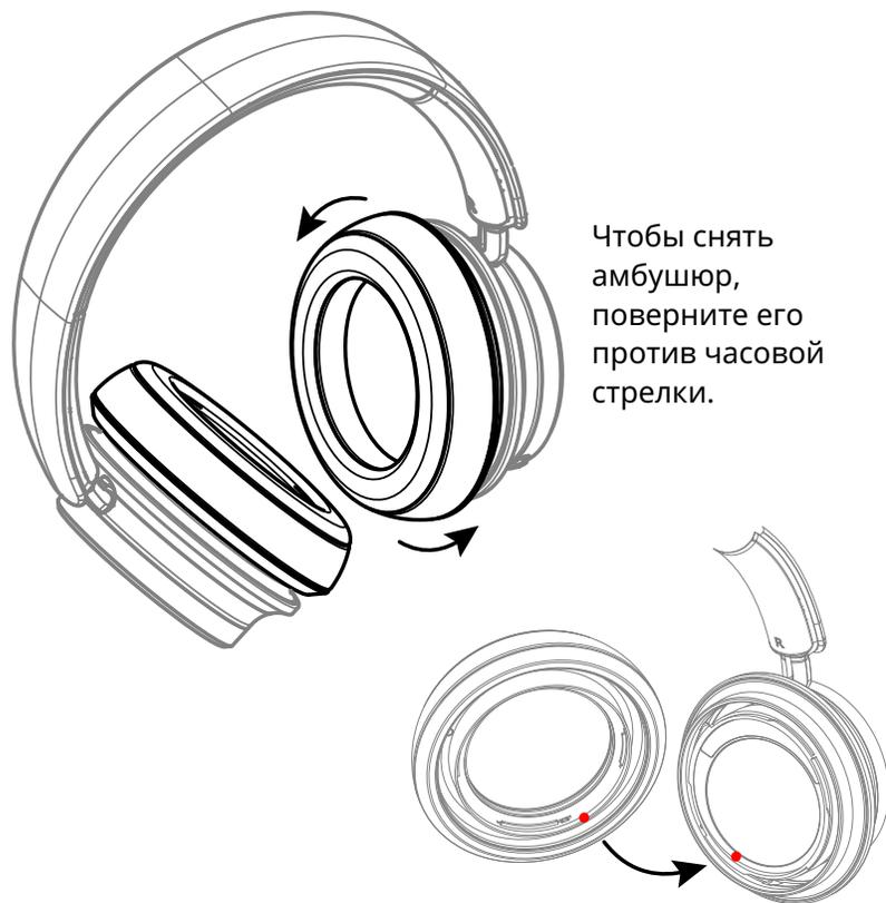
Чтобы снять амбушюр, поверните его против часовой стрелки.
